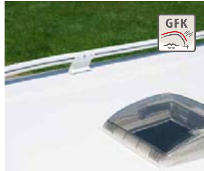
+ Dach, Bug und Heck aus widerstandsfähigem GFK
