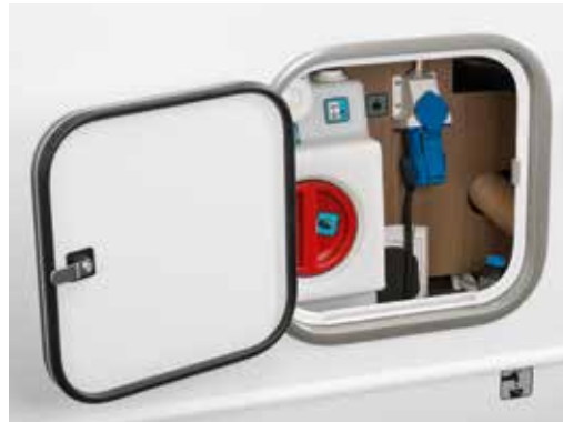
Service-Zugang für Frischwassertank-Befüllung und -reinigung, 230 V Anschluss, Boiler-Entleerung
