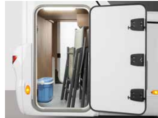
Dank Chassis-Absenkung hohe Heckgarage mit Durchlademöglichkeit
