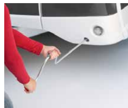
+ Kurbel-Einführhilfe zur bequemen Bedienung der Kurbelstützen
