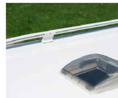
+ Robustes GFK-Dach zum Schutz vor Hagel und Ästen
