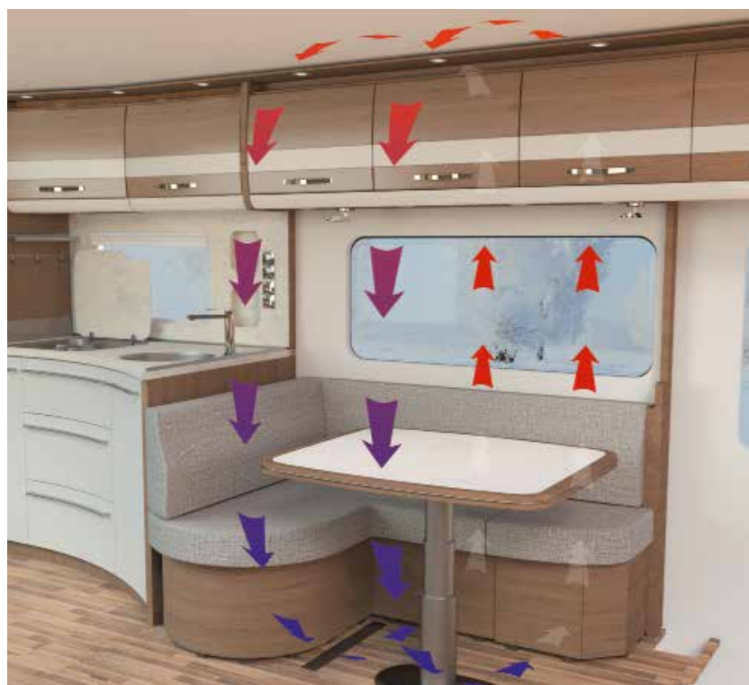
+ AirPlus-System zur Hinterlüftung der Dachsränke (siehe Seite 63)
