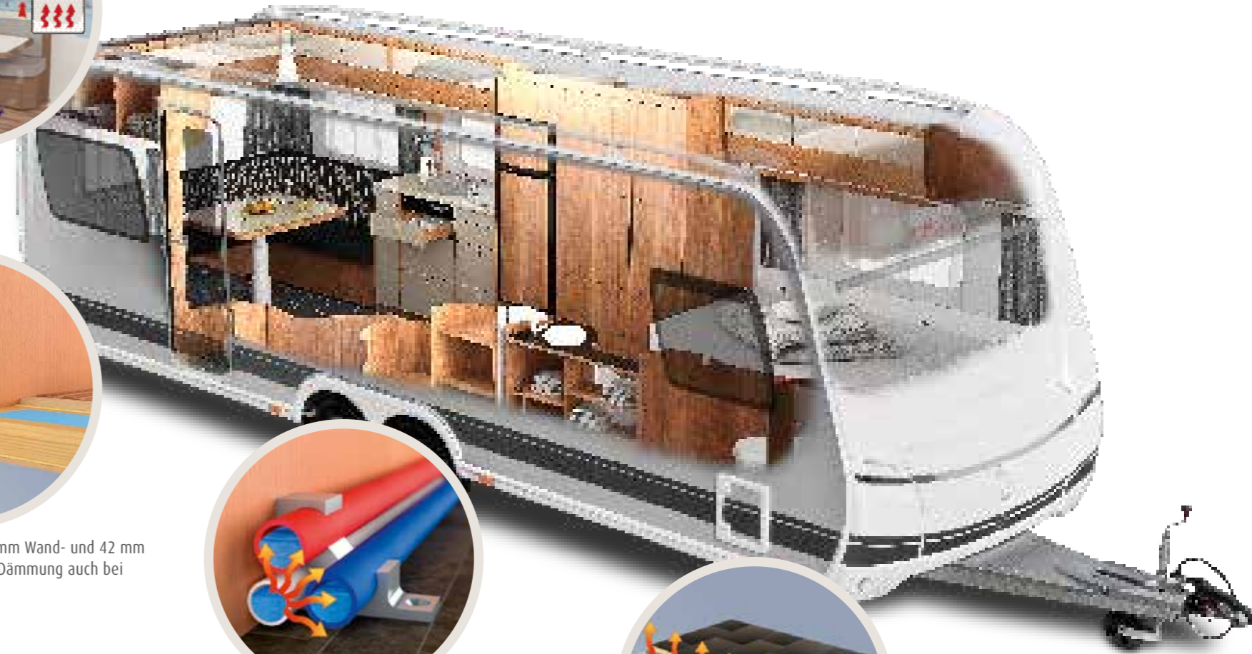
+ Die Wasserleitungen werden direkt auf den Heizrohren verlegt und so vor Einfrieren geschützt (Abb. Warmwasserheizung)
