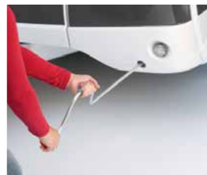
+ Kurbel-Einführhilfe zur bequemen Bedienung der Kurbelstützen
