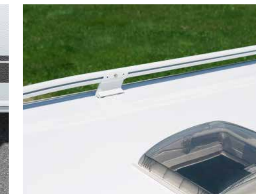
+ Robustes GFK-Dach zum Schutz vor Hagel und Ästen
