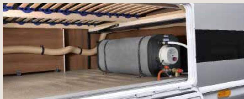
+ Perfekter Duschkomfort: Leistungsstarker 30-l-Warmwasserboiler
