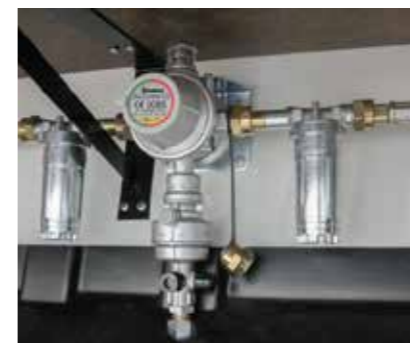
+ Gasdruckregler mit Crashesensor unterbricht Gaszufuhr im Falle eines Aufpralls
